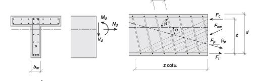
Spannungsfeld für die Bemessung von Trägerstegen
