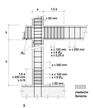
Konstruktive Durchbildung von Riegeln und Stützen
