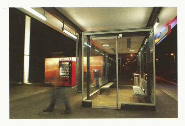
Thörishaus (BE): Beleuchtungskomposition aus Lichtstele (Railbeam), in diffusem Fluoreszenzlicht leuchtender Kommerzwand und warmweissen, in die Decke der Wartehalle eingelassenen, blendfreien Leuchten (Bild: GIM Architekten)
