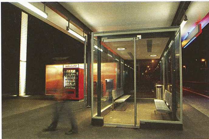
Thörishaus (BE): Beleuchtungskomposition aus Lichtstele (Railbeam), in diffusem Fluoreszenzlicht leuchtender Kommerzwand und warm-weißen, in die Decke der Wartehalle eingelassenen, blendfreien Leuchten (Bild: GIM Architekten)
