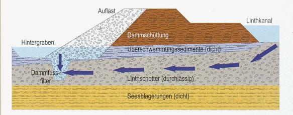
Der Auflast- und Dammfussfilter besteht aus einer Auflast und einem mit Schotter gefüllten Entlastungsschlitz auf der Luftseite des Hochwasserschutzdammes
