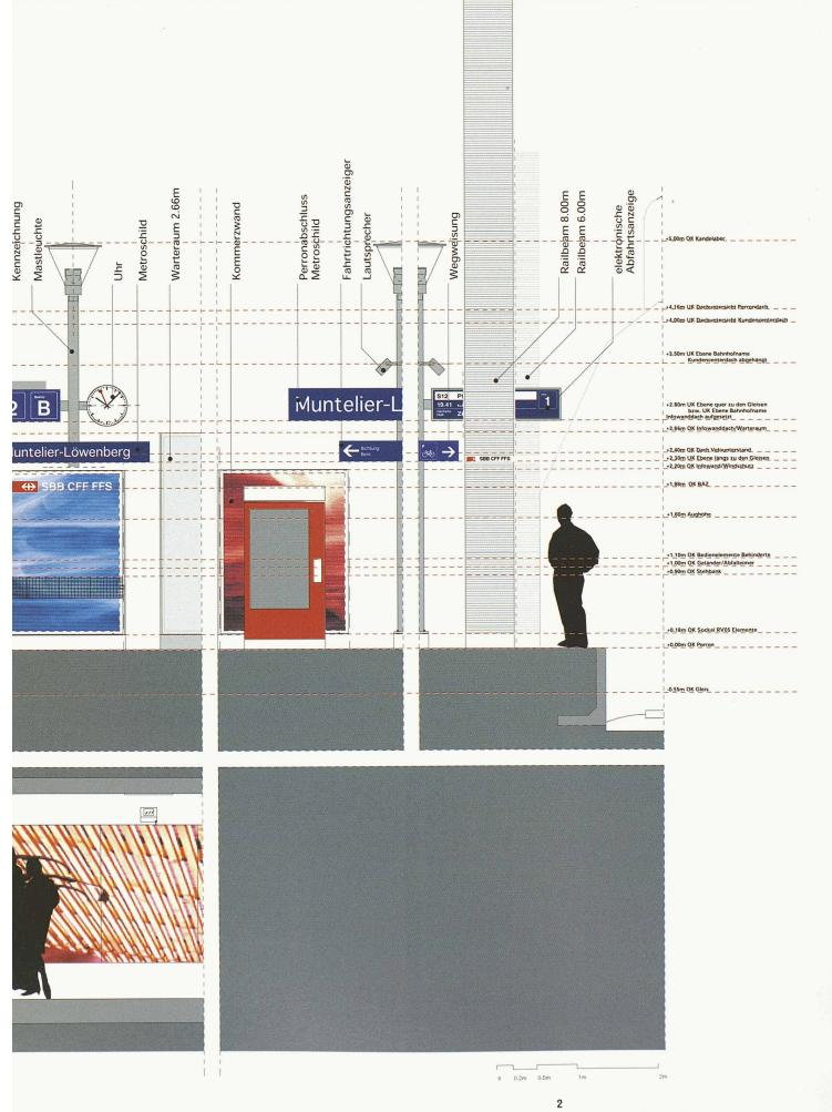
Die Standardisierung der Elemente erlaubt einen modulartigen Aufbau, der sich an der Grösse der Station orientiert (Bild: GIM Architekten)
