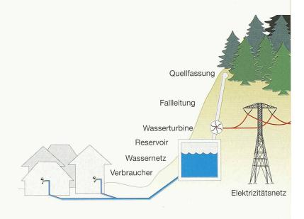
Ungenutztes Potenzial: In der Schweiz besteht zwischen Quellfassung und Trinkwasser-Reservoir vielerorts ein beträchtlicher Höhenunterschied, der zur rentablen Stromerzeugung genutzt werden könnte (Bilder: Energie in Infrastrukturanlagen)
