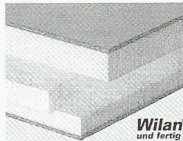
Isolationselemente **einseitig** belegt mit äußerst widerstandsfähigen Fertigdeckenschichten aus Kunststoffen, Faserzement oder Holzwerkstoffplatten. Für das direkte Einlegen und einbetonieren in Deckenschalungen oder für nachträgliche Montagen.
