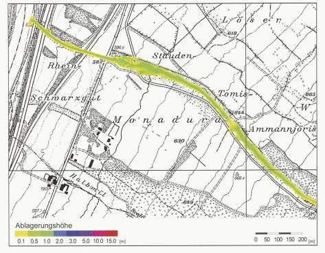
Numerische Simulationen mit dem Modell von O'Brien und Julien (1993) an der Maschänserrüfe bei Trimmis (GR): Ablagerungshöhen eines grösseren Murgangs oberhalb der Einmündung in den Rhein und im Bereich der Verkehrsträger (SBB, RhB, Nationalstrasse A 13, Hauptstrasse) (Bild: VAW)
