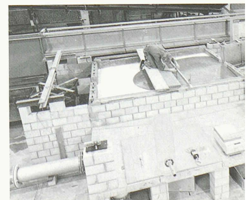
Physikalische Modellierung von Murgängen an der Versuchsanstalt für Wasserbau, Hydrologie und Glaziologie (VAW) der ETH Zürich: Ausbreitungsversuche zur Kalibrierung von Modellfluiden (Bild: VAW)
