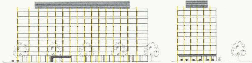
dämmt, hinterlüftet und mit Aluminiumpaneelen verkleidet.
