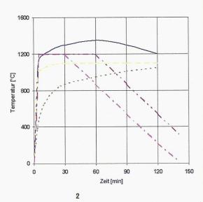
Temperatur-Zeit-Kurven für Brandbeständigkeitsuntersuchungen im Tunnel. *Blau:* Rijkswaterstaat (RWS), *violett:* RABT, *gelb:* Hydrocarbon, *grün:* Iso-834, *rosarot:* ZTV-Tunnel
