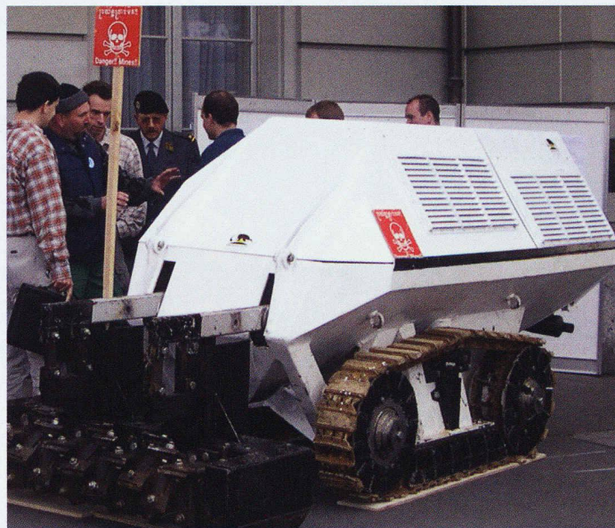
Das robuste, ferngesteuerte Raupenfahrzeug räumt die wuchernde Vegetation auf verminten Feldern und erleichtert die Räumung. Die mit dem ersten Preis gekrönte Arbeit der Entwicklungsgruppe Digger DTR der HTI Biel (Bilder: pps)
