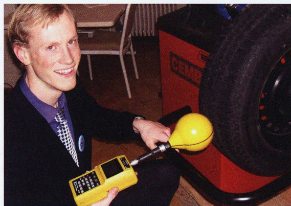
Das Gerät zur Messung der unerwartet hohen Magnetfelder an den Reifen des fahrenden Autos, dazu eine einfache Vorrichtung, um die Reifen zu entmagnetisieren: ein Beitrag zur Lebensqualität von Olivier Bécheiraz, HTI Biel
