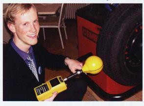
Das Gerät zur Messung der unerwartet hohen Magnetfelder an den Reifen des fahrenden Autos, dazu eine einfache Vorrichtung, um die Reifen zu entmagnetisieren: ein Beitrag zur Lebensqualität von Olivier Bécheiraz, HTI Biel
