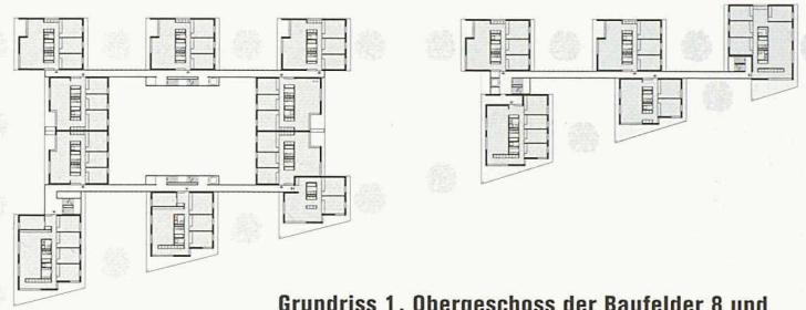
Grundriss 1. Obergeschoss der Baufelder 8 und 9. Eine einfache Wohnungstypologie der Etagenwohnungen (1. Rang, Regina + Alain Gonthier)
