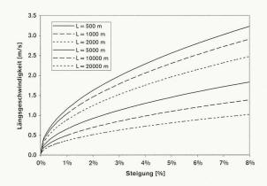
Berechnung der durch den Kamineffekt induzierten Längsgeschwindigkeit im Brandfall (Lastwagenbrand, 30 MW) als Funktion der Tunnelsteigung für verschiedene Tunnellängen
