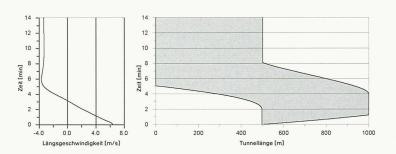
Simulation der zeitlichen Entwicklung der Längsgeschwindigkeit am Brandort (links) und Rauchausbreitung (rechts) in einem Richtungsverkehrstunnel (Verkehr von links nach rechts) mit einem Gefälle von 3%. Bei Verkehr in fallender Richtung gefährdet die natürliche Rauchausbreitung die stromaufwärts vom Brand blockierten Fahrzeuge, falls keine adäquaten lüftungstechnischen Massnahmen ergriffen werden (Simulationsprogramm TunSim 1.5, vom Autor entwickelt)
