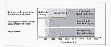
4 Einsatzbereiche der Lüftungssysteme gemäss der Schweizerischen Richtlinie Tunnellüftung. In den Übergangsbereichen sind weitere Einflussfaktoren, wie die Verkehrsmenge (gesamt und Lkw-Anteil) und die Tunnelsteigung, zu berücksichtigen
