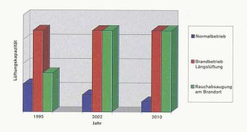
Schematische Darstellung der Anforderungen an Tunnellüftungen im Normalbetrieb und im Brandfall. Die Luftmengen sind vor allem von der Tunnellänge und vom Verkehrsaufkommen abhängig
