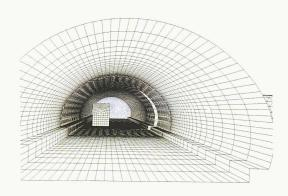
7 3D-Oberflächengitter für die Simulation eines Lastwagenbrandes im Tunnel
