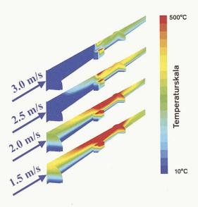
Simulation der Rauchschichtung als Funktion der Längsgeschwindigkeit in einem Richtungsverkehrstunnel (Länge 1575 m, Gefälle von 5% in Strömungsrichtung, von links nach rechts, 30 MW Lastwagenbrand, im Bild sichtbar). Temperaturverteilung im Tunnel, asymptotischer Zustand (Längsschnitte durch die Tunnelachse). Die Ergebnisse der Simulation bestätigen die theoretische Analyse, welche einen Wert der kritischen Längsgeschwindigkeit von etwa 2,5-3 m/s ergeben hatte
