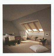
ter weist über den ganzen Baukörper bei der Fenstergrösse 114 x 140 cm einen für Dachflächenfenster bis jetzt unerreichten Wärmedurchgangswert von Uw = 0,9 W/m²K auf. Mit einem zusätzlichen Verdunkelungsrollo innen kann dieser Wert sogar auf Uw = 0,8 W/m²K gebracht werden. Zudem besitzt das Velux-GGL 64 einen Schalldämmwert von Rw = 40 dB.
