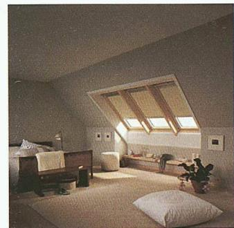
ter weist über den ganzen Baukörper bei der Fenstergrösse 114 x 140 cm einen für Dachflächenfenster bis jetzt unerreichten Wärmedurchgangswert von  $U_w = 0,9 \text{ W/m}^2\text{K}$  auf. Mit einem zusätzlichen Verdunkelungsrollo innen kann dieser Wert sogar auf  $U_w = 0,8 \text{ W/m}^2\text{K}$  gebracht werden. Zudem besitzt das Velux-GGL 64 einen Schalldämmwert von  $R_w = 40 \text{ dB}$ .
