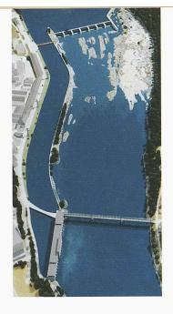
Modell des geplanten neuen Wasserkraftwerks Rheinfelden: Das neue Stauwehr wird als erste Etappe bis Mitte 2007 fertig sein. Rechts unter dem Wehr die besondere Felsformation, das «Gwild», das weitgehend erhalten bleiben soll; unten links das alte Kraftwerk
