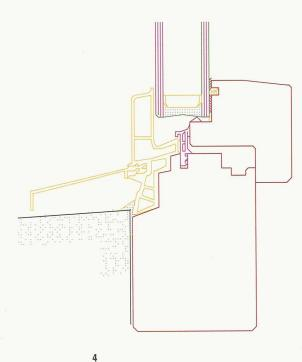
Holz-Glas-Verbundfenster. Das IV-Glas wird mit einem speziellen Kleber direkt auf dem Flügelrahmen angebracht. Damit kann es (im Verbund mit dem Holzrahmen) Windkräfte aufnehmen und ermöglicht die Reduktion der Holzquerschnitte. Massstab 1:2 (Bild: Tschopp Zwissig)
