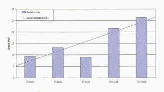
Belastung im Fussbereich Beifahrerseite in Abhängigkeit der Geschwindigkeit (prozentualer Anteil am Grenzwert) (Bilder: HTI Biel)
