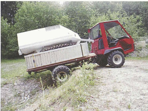
Das Digger D-1 kann auf einem Kleintransporter zum Minenfeld geführt werden (Bilder: Digger DTR)
