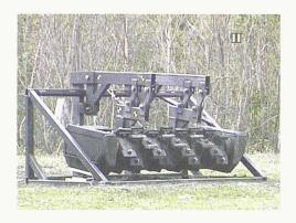
2 Digger-Fräse: Die Rodungsfräse wird auf Unzerstörbarkeit bei Explosionen getestet
