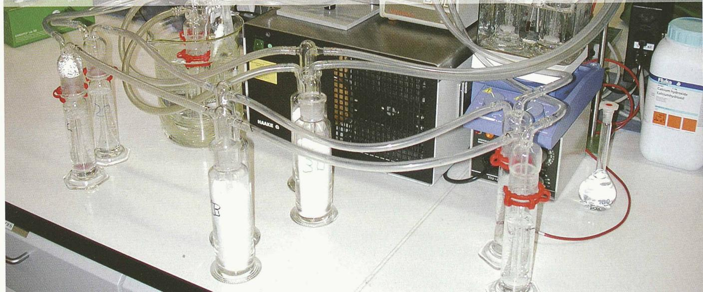
Im Laborversuch wird das für moderne SCR-Katalysatoren benötigte Ammoniakwasser auf enzymatischem Weg aus einer Harnstofflösung erzeugt.
