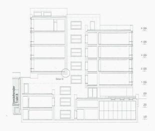
5 Querschnitt 1-1. Die beheizten Zonen sind grau angelegt. Schnitt durch die offene Eingangshalle und den mit ihr verschränkten Lichthof, der nach oben und in die Untergeschosse greift. Rechts die teilweise auskragenden südlichen Klassenzimmer (Plan Architekten, Mst. 1:500)
