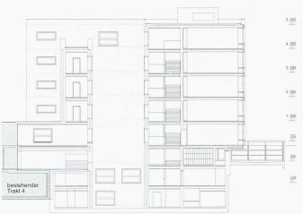
6 Längsschnitt 2-2. Schnitt durch den offenen Lichthof. Links die Verbindung zu einem bestehenden Trakt (Plan Architekten, Mst. 1:500)
