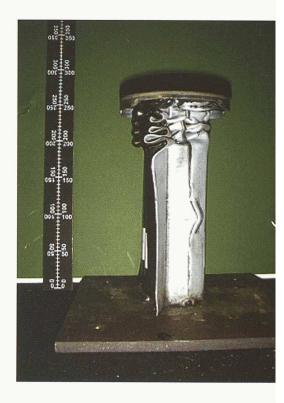
Geklebter Motorträger nach Crashbeanspruchung (Bild und Teile: Sika Services AG)
