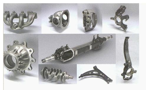
Anwendungen von Eisenguss im Antrieb (Bild: Georg Fischer Fahrzeugtechnik AG)
