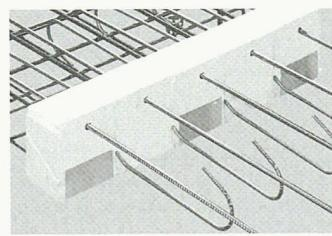
gungen verzichten. Mit dieser neuartigen Konstruktion können die Grenzwerte für lineare Wärmebrücken-Zuschläge eingehalten und unterschritten werden. Sie betragen 0,090 bis 0,20 W/mK (Grenzwert 0,30 W/mK gemäss SIA 380/1). Weitere Informationen und detaillierte Unterlagen sind erhältlich bei:
