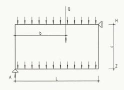
Statisches Modell einer durch Einbezug der Decke horizontal gelagerten Wandscheibe (Bild: Autor)
