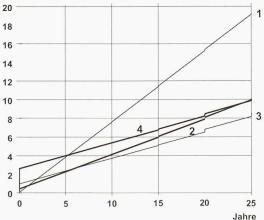
Aufsummierter Primärenergiebedarf für Heizung, Warmwasser, Haushaltstrom und Graue Energie für verschiedene Erneuerungsvarianten für ein 24-Familien-Haus aus den 50er-Jahren (inkl. Graue Energie für periodische Unterhaltsarbeiten)
