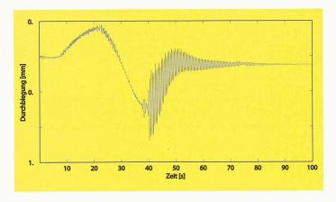
3 Zeitverlauf der Durchbiegung im Bogen-Viertelspunkt während der zentrischen Fahrt des Versuchsfahrzeugs mit 157 kN Bruttolast mit einer Geschwindigkeit von 10 km/h und Brettanregung bei der Messstelle
