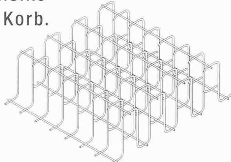
FIDECA®, die neuartige Schubbewehrung (Euro Pat.) von Fischer Rista, gibt Gebäuden schon beim Bauen mehr Sicherheit. Die Schubkörbe mit ihrer wellenförmigen Konstruktion ermöglichen eine kontinuierliche Verankerung. So wird das Risiko des Durchstanzens durch Bodenplatten oder Betondecken ausgeschlossen.
