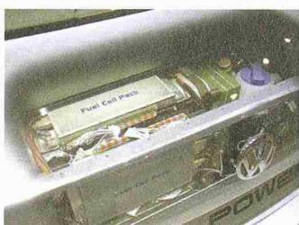
tor eines vergleichbaren Fahrzeugs. Herzstück des neu entwickelten Antriebs sind Brennstoffzellen, die aus Wasserstoff Elektrizität
