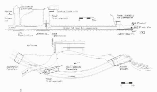
Längsschnitt und Situation Grundablass (Bilder: BKW FMB)
