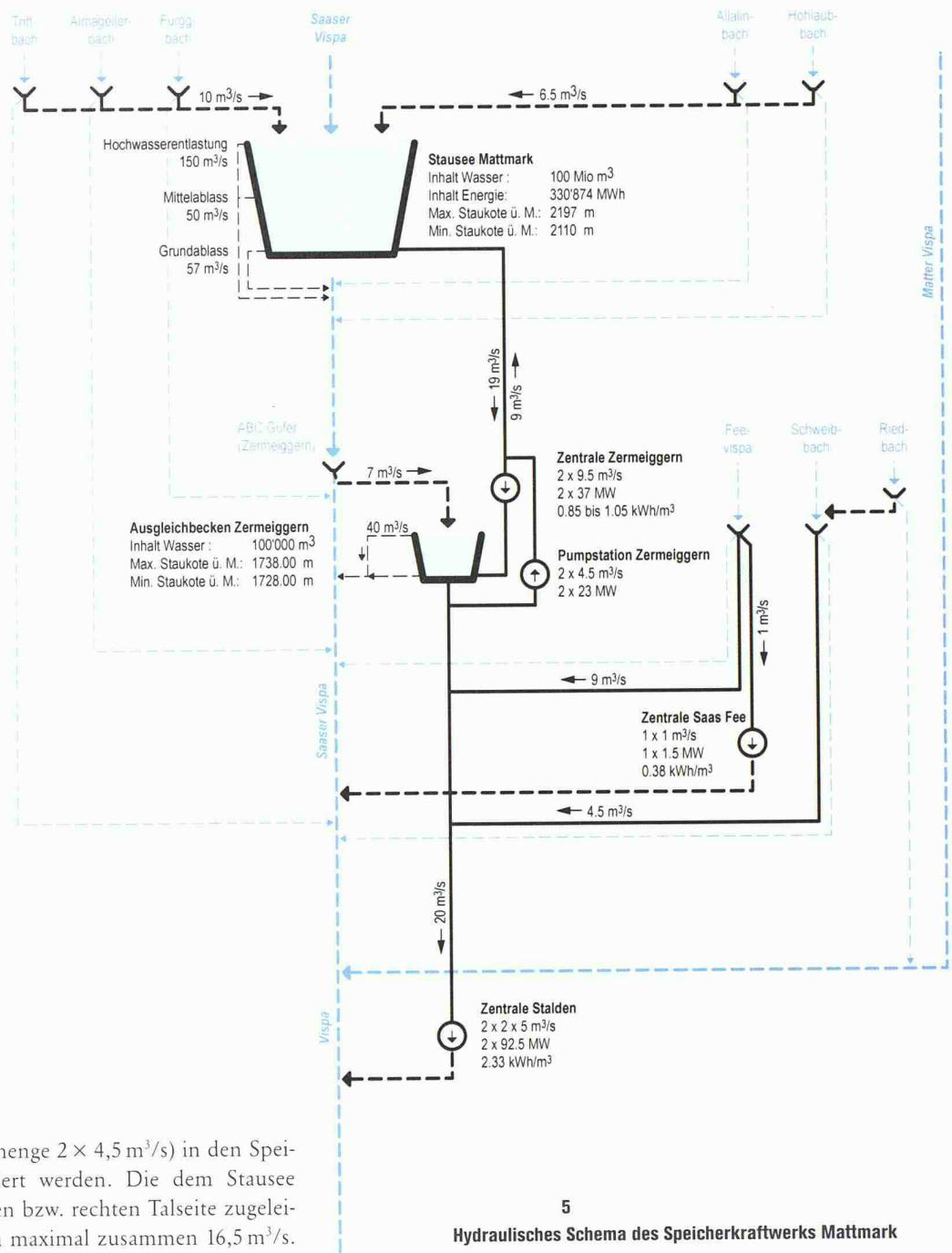
station (Ausbauwassermenge  $2 \times 4.5 \text{ m}^3/\text{s}$ ) in den Speicher Mattmark gefördert werden. Die dem Stausee künstlich von der linken bzw. rechten Talseite zugeleiteten Zuflüsse betragen maximal zusammen  $16.5 \text{ m}^3/\text{s}$ . Dadurch steht der Stauanlage ein nutzbares Gesamt-Einzugsgebiet von  $88.2 \text{ km}^2$  zur Verfügung, welches zu 45 % vergletschert ist.
