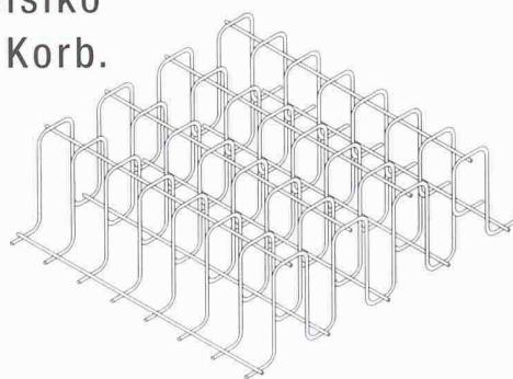
FIDECA®, die neuartige Schubbewehrung (Euro Pat.) von Fischer Rista, gibt Gebäuden schon beim Bauen mehr Sicherheit. Die Schubkörbe mit ihrer wellenförmigen Konstruktion ermöglichen eine kontinuierliche Verankerung. So wird das Risiko des Durchstanzens durch Bodenplatten oder Betondecken ausgeschlossen.
