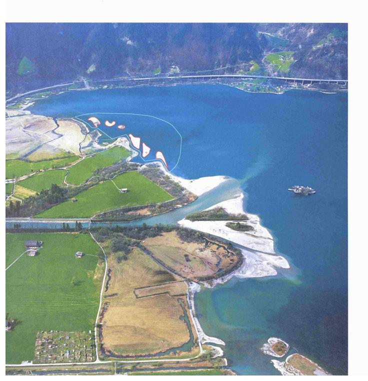
neigung und -gestaltung im obersten Teil durch die Welleneinwirkungen bestimmt. Die Schüttergebnisse werden laufend mittels Echolot und GPS (Global Positioning System) ermittelt. Zusätzlich führt ein Spezialist periodisch unabhängige und zusammenhängende Kontrollmessungen in Bezug auf die Geometrie der Schuttkörper durch.
