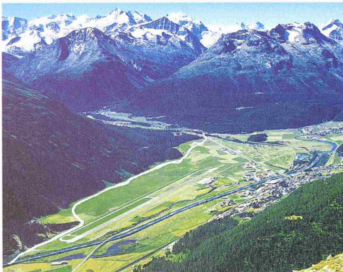
Der Flaz, der heute kanalisiert in Samedan in den Inn mündet, erhält ein 17 km langes neues Flussbett auf der anderen Seite des Flugplatzes (hell eingezeichnet). Damit wird die Hochwassergefahr für Samedan vermindert, gleichzeitig wird die Landschaft ökologisch aufgewertet
