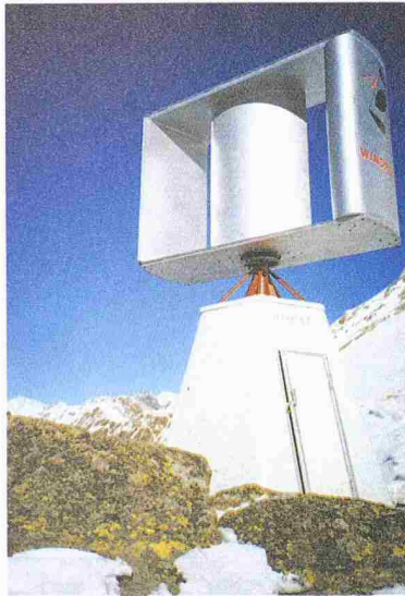
Windenergieanlage mit Vertikalrotor
