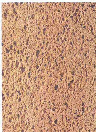
Neuer Holzwerkstoff: Stärkegebundene leichte Holzplatten (SLP) aus Sägemehl, Wasser, Hefepilzen und anderen Mikroorganismen enthalten keinen Leim, sind leicht und wie Holz zu bearbeiten (Bild: pd)
