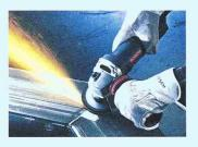
Zusatz-Handgriff. Im Vergleich zum Standardgriff eines Winkelschleifers verringert der neue Handgriff Vibration Control die unangenehmen Vibrationen auf weniger als ein Drittel.
