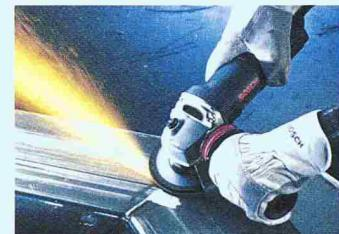
Zusatzz-Handgriff. Im Vergleich zum Standardgriff eines Winkel schleifers verringert der neue Handgriff Vibration Control die unangenehmen Vibrationen auf weniger als ein Drittel.
