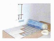
Die 8 mm dünnen und diffusionsdichten Vor- und Rücklaufrohre aus Polybutyl sind nebeneinander in Schlaufen auf einem Nylongittergewebe aufmontiert. Ein zweites Gewebenetz als Armierung über den Rohren garantiert einen rissfreien Boden. Nach der Installation werden die Rohrmatten mit selbstnivellierendem Flächenspachtel bündig übergossen, und
