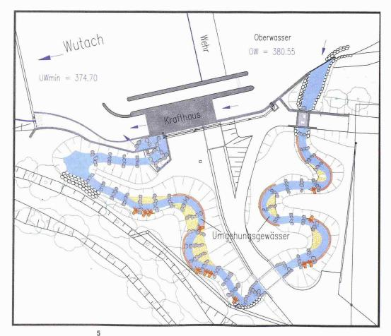
Lageplan Umgehungsbach WKA Wutöschingen an der Wutach (D, Baden-Württemberg). Höhenunterschied: 5,85 m; Länge: 150 m; Gefälle: 4 %; Breite: 3-4 m; Abfluss: 0,35 m<sup>3</sup>/s (Bild: Rolf-Jürgen Gebler)
