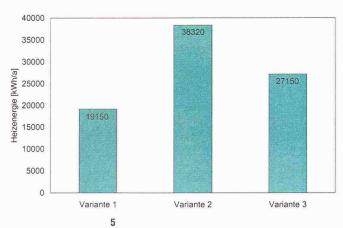
Darstellung der abgeführten Energiemengen bei den drei Hausvarianten (total Heizenergie). Die Qualität der Energie wird hier nicht gewertet
