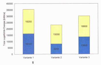
Dem Gebäude zugeführte Exergieströme: Betrieb (blau) und Graue Energie (gelb).
