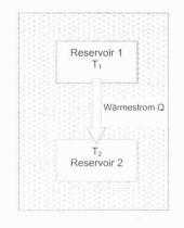
Bei einer Innentemperatur von 20°C und einer Aussentemperatur von 0°C könnten theoretisch 90 % der Heizenergie aus der Umgebung gewonnen werden
