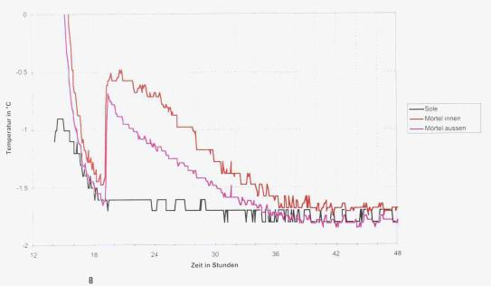
Typischer Temperaturverlauf beim Abkühlen eines handelsüblichen Mörtels, der vor dem Abbinden gefriert. Der starke Temperaturanstieg nach 19 Stunden ist auf das Freiwerden der Gefrierwärme zurückzuführen (Bild: Konrad Moser)
