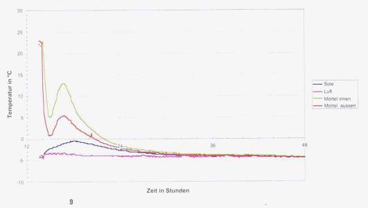
Typischer Temperaturverlauf eines schnell abbindenden Ankermörtels. Die Temperatur bleibt vor der Hydratation immer über dem Gefrierpunkt. Der nach 15 Stunden zu beobachtende Temperaturanstieg erfolgt wegen der frei werdenden Abbindewärme (Bild:-... Konrad Moser)
