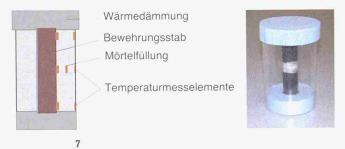
Schema des Prüfkörpers mit Temperaturmessstellen und leere Schalung eines Prüfkörpers (Bild: Konrad Moser)
