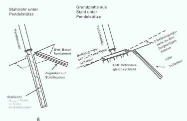
Schematische Darstellung zweier möglicher Fundationstypen für Pendelstützen (Bild: Patrik Thalparpan)
