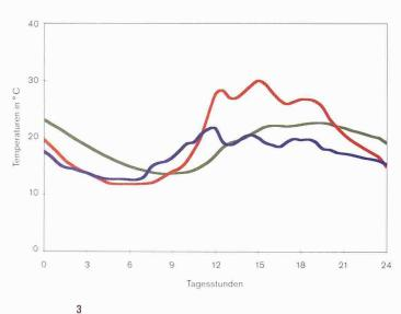
Lufttemperatur versus Dachtemperatur mit und ohne Dachbegrünung (grün: Unterkante Gründach, rot: Unterkante Kiesdach, blau: Lufttemperatur)
