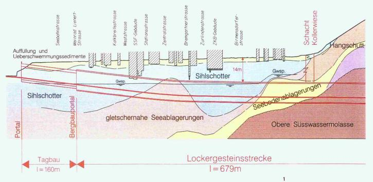
Geologisches Profil der Lockergesteinsstrecke des SBB-Tunnels 2. Doppelspur Zürich-Thalwil (Bild SBB)
