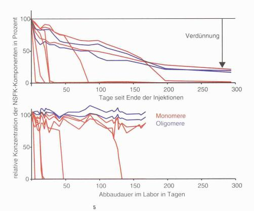
Biologischer Abbau der NSFK-Komponenten auf der Baregg-Baustelle (oben) und im Labor unter kontrollierten Bedingungen (unten). Die Konzentrationen sind an der jeweiligen Anfangskonzentration normiert. Die fast lineare Konzentrationsabnahme der drei nicht abbaubaren NSFK-Komponenten im Bild oben ist auf die Verdünnung der Schadstofffahne mit Grundwasser zurückzuführen (Bild Sabine Ruckstuhl)
