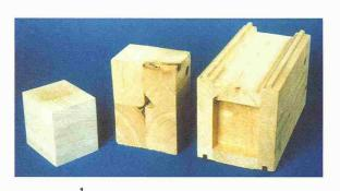
Aus Vollholz aufgebaute Holzwerkstoffe: Brettschichtholz; Kreuzbalken; Lignaturbalken (von links nach rechts)
