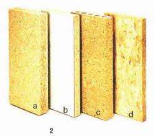
Spanplattenwerkstoffe: a) Flachpressplatte; b) Flachpressplatte beschichtet; c) Strangpressplatte mit Ausrichtung der Späne senkrecht zur Oberfläche; d) Spanplatte mit flächigen und lagenweise zur Oberfläche angeordneten Spänen (OSB)
