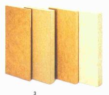
Faserplattenwerkstoffe: Hartfaserplatte (ohne Bindemittel), Rohdichte > 850 kg/m³; Mitteldichte Faserplatte (MDF), Rohdichte ca. 600 kg/m³; Weichfaserplatte (ohne Bindemittel), Rohdichte ca. 250 kg/m³; Holzfaserdämmplatte (ohne Bindemittel), Rohdichte ca. 160 kg/m³ (von links nach rechts)
