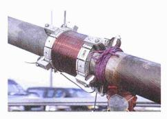
verschoben und mit Sensoren kontinuierlich das erzeugte Magnetfeld gemessen wird, so lässt sich feststellen, wo überall Fehlstellen im Inneren des Seils vorhanden sind. Ein Feldversuch in Bangkok verlief viel versprechend. Zurzeit befindet sich die Messausrüstung in einer Optimierungsphase. Die Rechte zur Nutzung der Empa-Entwicklung werden interessierten Branchen in Lizenzverträgen übertragen.
