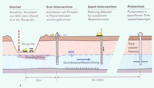
Geländeschnitt mit Baustelle und Trinkwasserfassung. Bei einem Störfall (Beispiel: Versickerung von Dieselkraftstoff in der Baugrube) sind verschiedene Stufen von Interventionen vorgesehen
