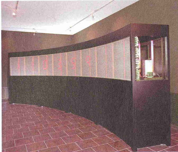
Bio-Wall: ein Rechner mit der Fähigkeit, sich selber zu «heilen» und zu replizieren (Bild: ETH Lausanne)
