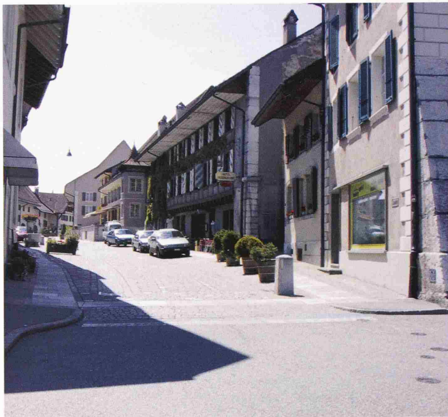
Flankierende Massnahmen in Wiedlisbach BE. Eingangsbereich zum Städtchen. Die alten Gehsteige waren lediglich einen Meter schmal und wurden durch ortsgerecht gestaltete und dimensionierte Seitenbereiche ersetzt (Bild: Metron)
