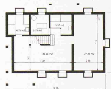
Pläne von oben nach unten: Obergeschoss, NF 76 m 2 ; Erdgeschoss, NF 85 m 2 ; Untergeschoss, NF 79 m 2 . Das Kellergeschoss, das an der Saffa-Ausstellung 1928 nicht existierte und erst in Aarau neu erstellt wurde, wird beim Wiederaufbau neu gebaut werden (Bilder: aus der Dokumentation des Vereins proSAFFAhaus, Küsnacht)
