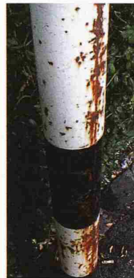
Links: Der feuerverzinkte Strassenpfosten weist dank hoher mechanischer Beständigkeit und kathodischem Schutz trotz Beschädigungen keine Rostbildung auf. Rechts: Der lackierte Strassenpfosten bildet nach Beschädigungen Rost
