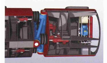
Schnittansicht durch die Pelamis. Die Segmente sind via hydraulische Pumpen verbunden (Bild: Ocean Power Delivery Ltd.)
