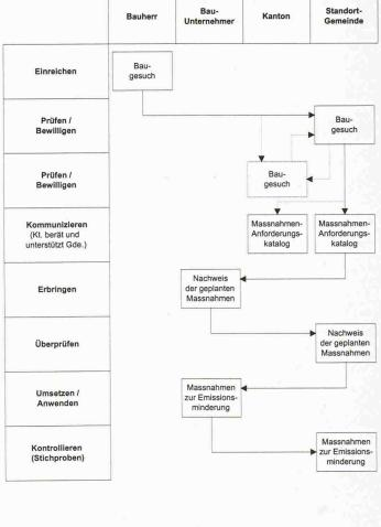
5 Beispiel Ablaufplanung Tiefbau: Zuständigkeit und Tätigkeiten (Bild: Ch. Leuenberger)
