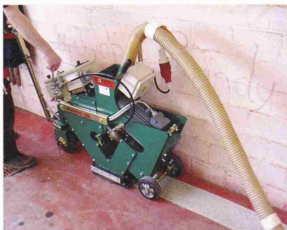
Strahlmaschine im Einsatz beim staubfreien Arbeiten (Bild: Ch. Leuenberger)
