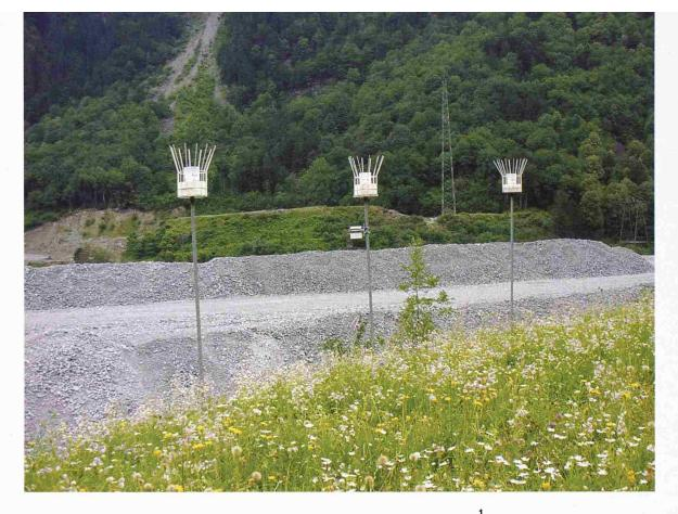
Keine Beleuchtung, sondern Geräte zur Messung der Staubbelastungen (Bild: Ch. Leuenberger)
