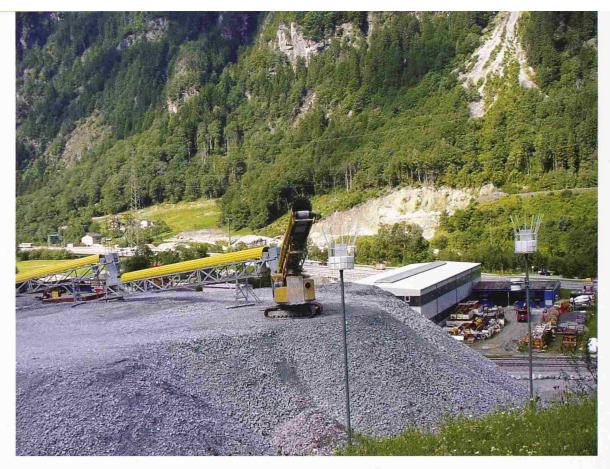
7 Abgedeckte Förderbänder und Übergabestationen vermindern die Staubbelastung (Bild: Ch. Leuenberger)
