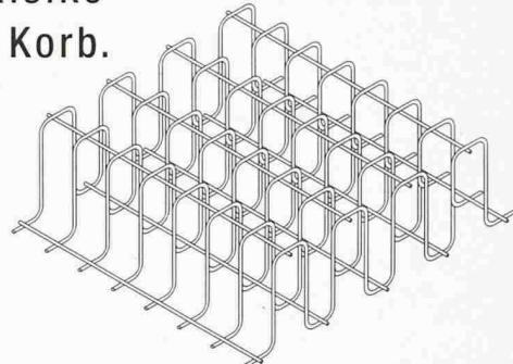
FIDECA®, die neuartige Schubbewehrung (Euro Pat.) von Fischer Rista, gibt Gebäuden schon beim Bauen mehr Sicherheit. Die Schubkörbe mit ihrer wellenförmigen Konstruktion ermöglichen eine kontinuierliche Verankerung. So wird das Risiko des Durchstanzen durch Bodenplatten oder Betondecken ausgeschlossen.
